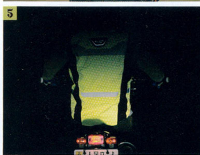
このベストはマクナ独自の反射素材がプリントされているので、ベスト自体が発光するわけではない。ヘッドライトや街灯の光を受け、その光を反射することで被視認性を向上する仕組みとなっている。それなので、光を受けていない時の夜間走行では、バイクのテールランプでライダー
