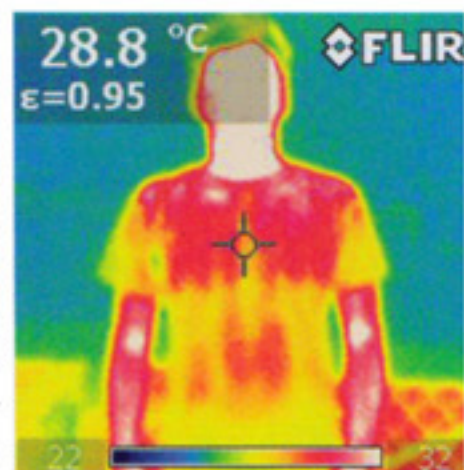
●右は気温27℃、湿度56%の日にジャベックスが行なった検証実験。人肌と同じくらいの温度にした水を注入し、うちわで風を当てる程度でも6℃くらい下がった。MACNA社はライダー向けのジャケットなどをリリースするオランダのメーカー
